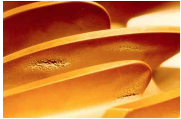
(b) Erosion sur une pale de pompe (extrait de Brennen [167])
