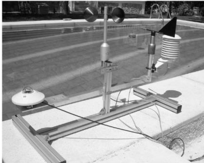
Figure 19 : Station météo de mesure de la vitesse du vent, de la température et l'humidité de l'air et pyranomètre installée pour l'expérimentation à 0.5 m de l'eau par Ruiz, et al. [62]
