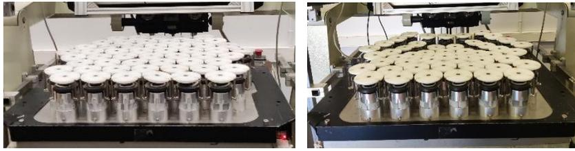
Figure 26 : Le siège expérimental avec une assise "plate" à gauche et "ergonomique" à droite
