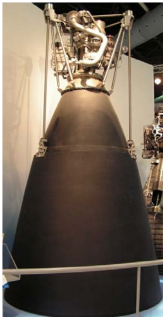
(a) Moteur Vinci avec divergent déployé.
