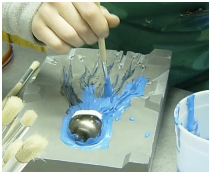
Ill. 82 : Une collaboratrice enduit au pinceau l'armature des cheveux d'Emily avec un mélange siliconé pour Les Noces funèbres
