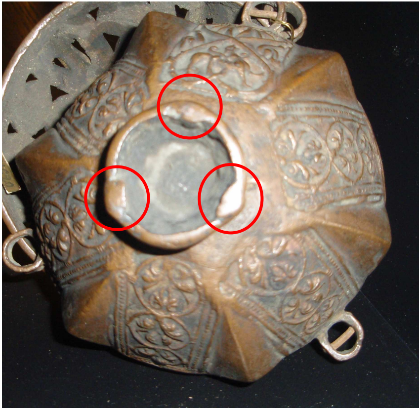
Figure 16 – Encensoir Cl. 11620, musée de Cluny – Il_75_par_mus_6 En rouge les défauts de fonte en gouttelettes
