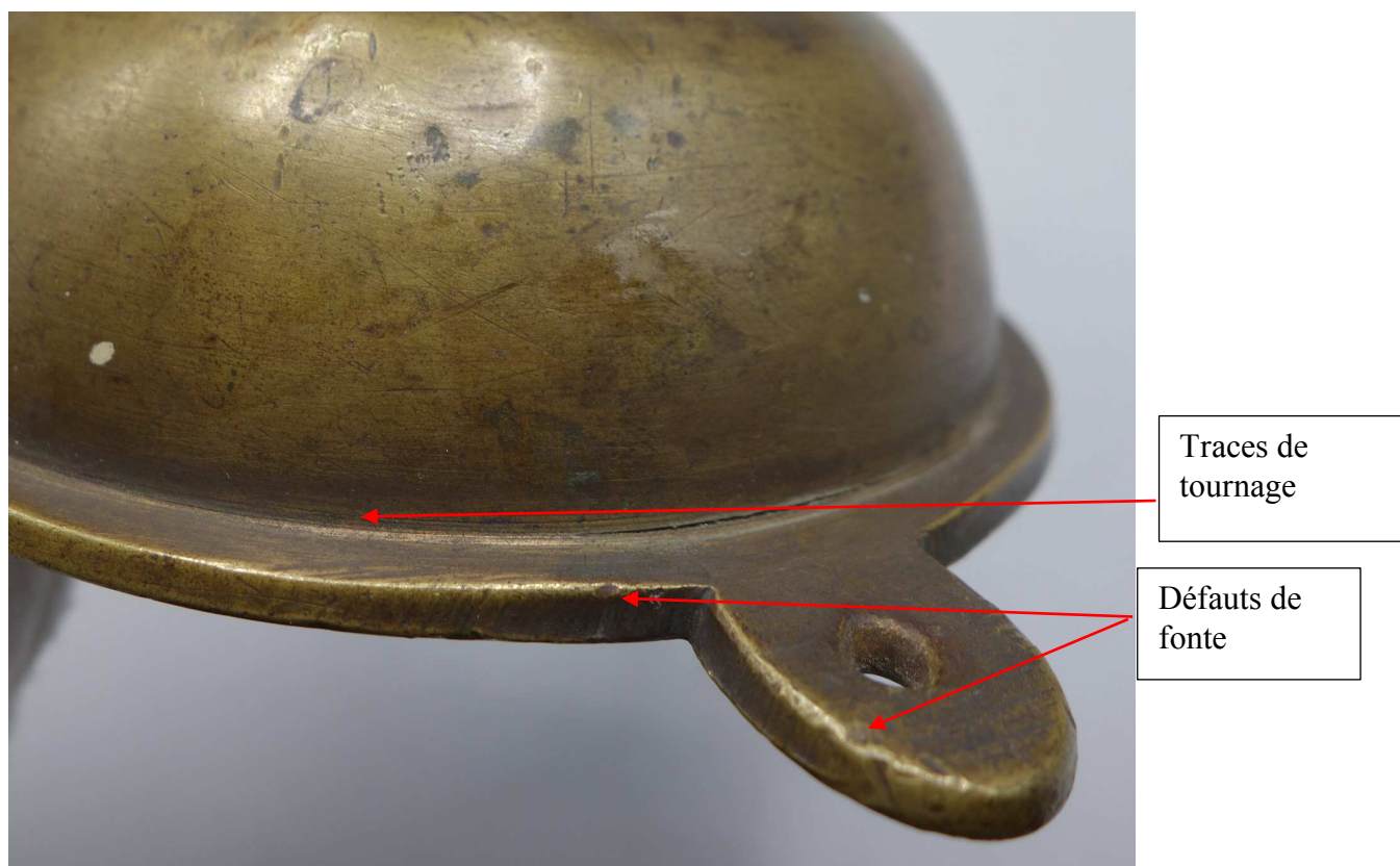
Figure 12 – Détail des traces de tournage à l'extérieur de la coupe ( Cl. Aude Chevalier – avril 2017).
