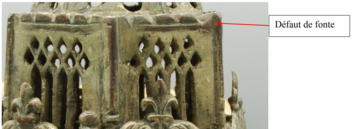
Figure 13 – Niveau supérieur de plaquettes avec défaut de fonte (Cl. Aude Chevalier – avril 2017)
