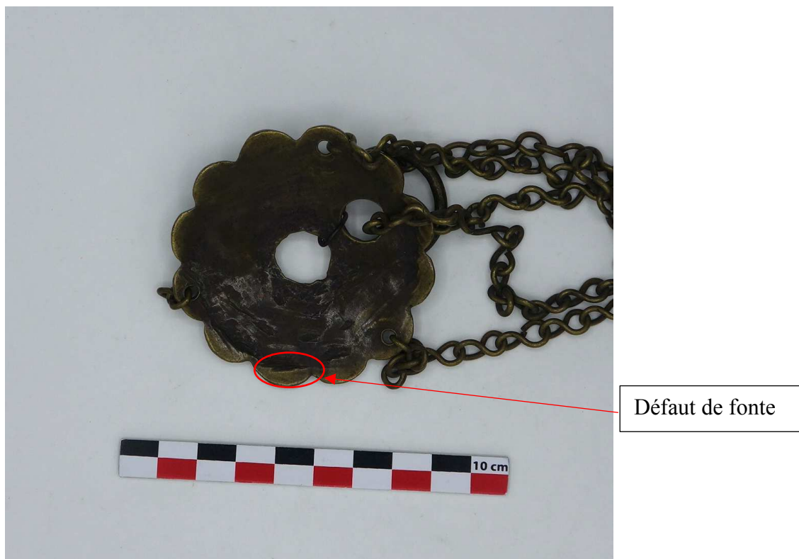
Figure 8 – Revers de la rondelle de préhension (Cl. Aude Chevalier – avril 2017)
