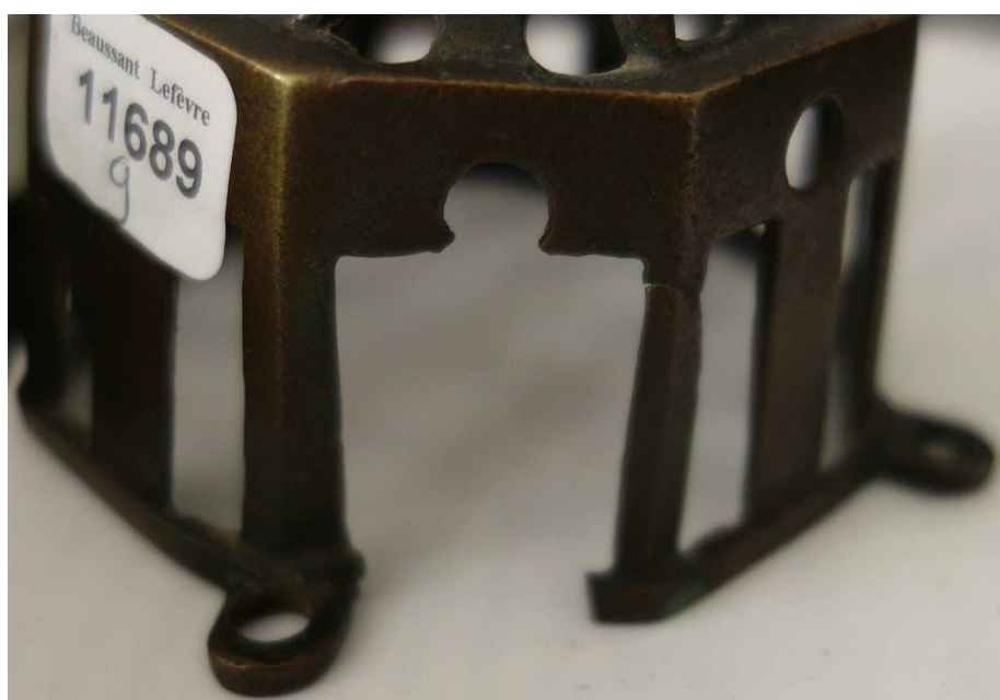
Figure 6 – Détail d’un pan brisé du couvercle (Cl. Aude Chevalier – septembre 2023)
