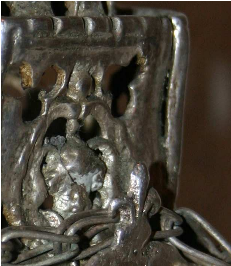
Figure 9 – Soudure entre deux plaquettes du niveau supérieur
