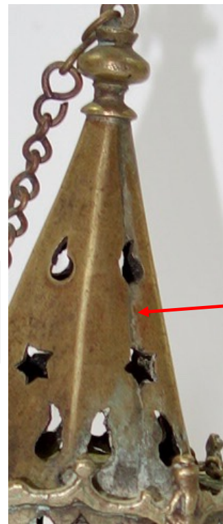
Figure 5 – Vue de la fissure de la flèche (Cl. Aude Chevalier – Avril 2017)
