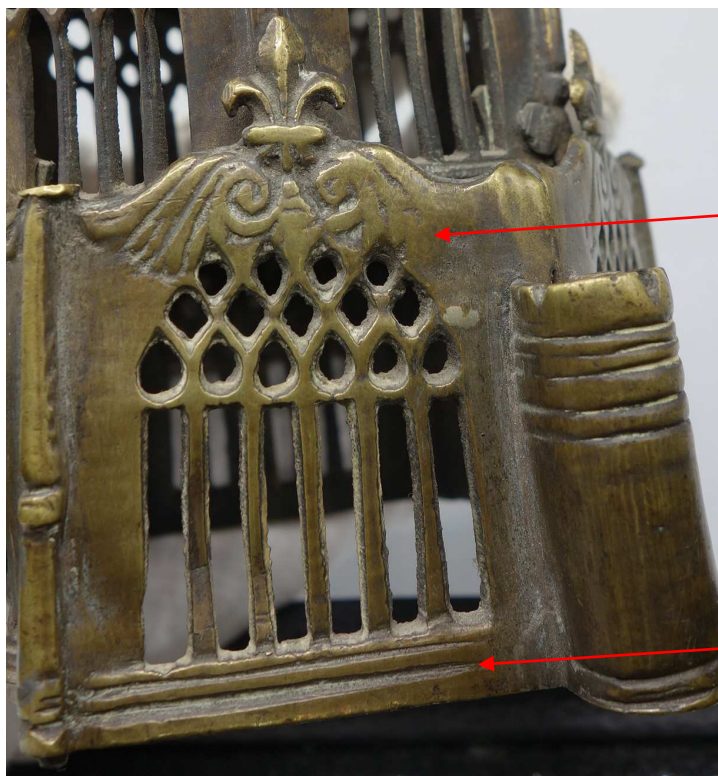
Figure 8 – Détail d'une plaquette du niveau inférieur du couvercle présentant un défaut de fonte (Cl. Aude Chevalier – mai 2017).
