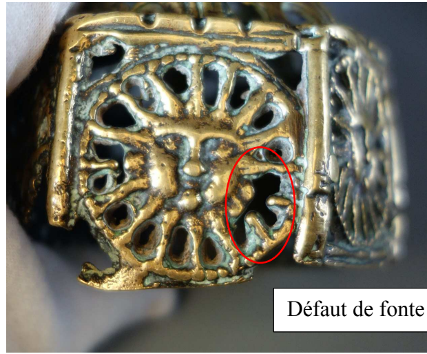
Figure 7 – Autre plaquette supérieure endommagée (Cl. Aude Chevalier – avril 2018)
