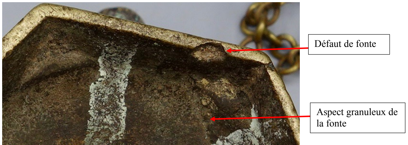
Figure 13 - Revers du pied – détail d'un défaut de fonte (Cl. Aude Chevalier – Avril 2017)
