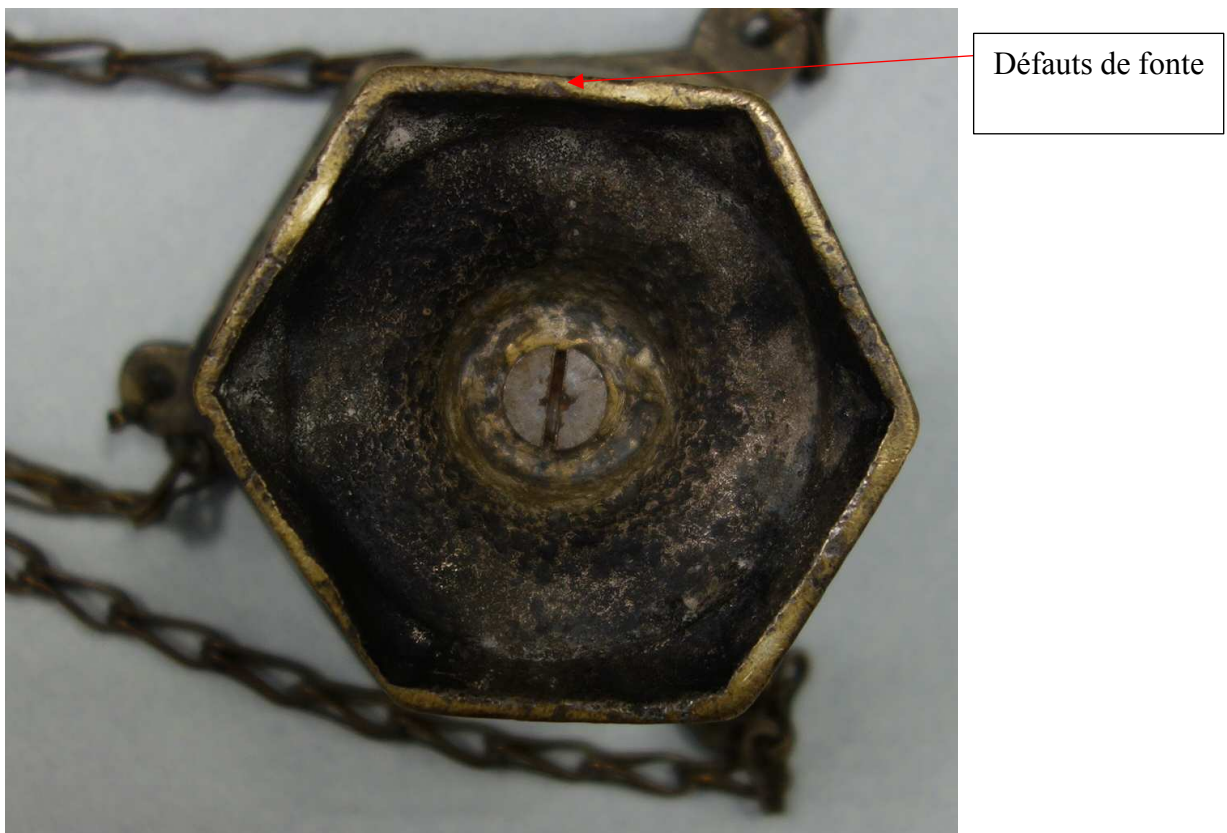
Figure 9 – Revers du pied, détail de la vis, détails de défauts de fonte (Cl. Aude Chevalier – février 2018)
