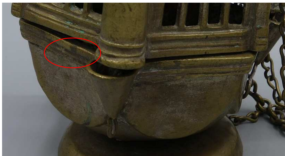
Figure 8 - Détail des lèvres de la coupe avec défauts de fonte (Cl. Aude Chevalier – mars 2018)
