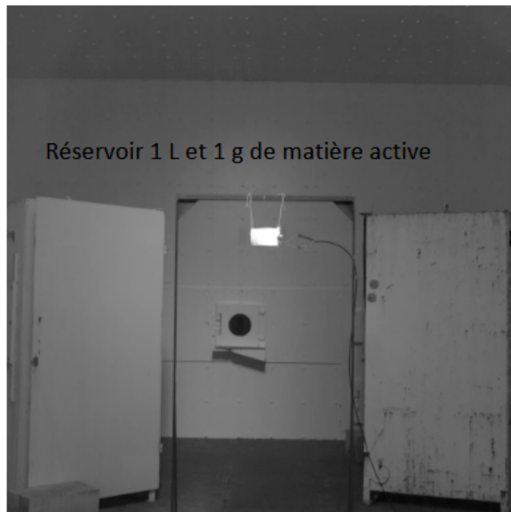
Figure A.2 – Banc de mesure d'ombroscopie pour la dispersion d'1 L d'eau avec 1 g de matière explosive.
