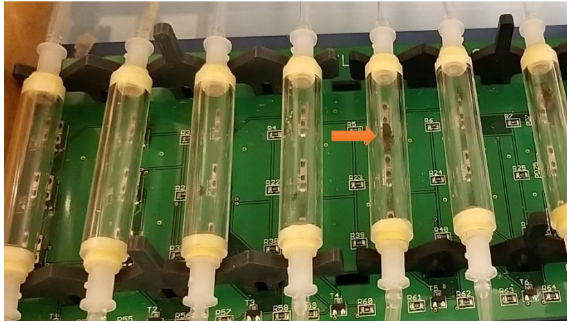
Figure 2 : système de chambres multiplexées de 2,4 \text{ cm}^3 (MAVEN™). Une reine Lasius niger est indiquée par la flèche orange.
