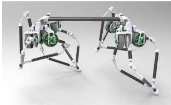
FIGURE 2.12 – Robot quadrupède utilisant des jambes GOAT.
