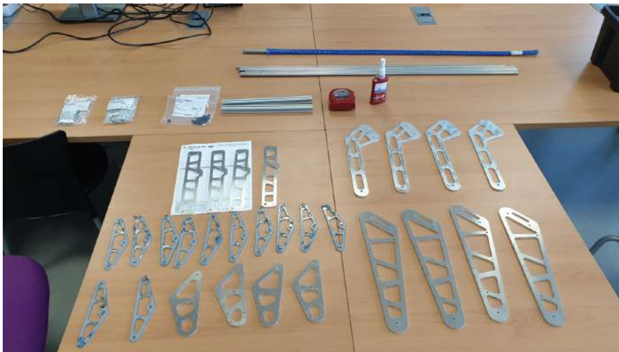
FIGURE 7.1 – Les différents éléments constituant le robot bipède.
