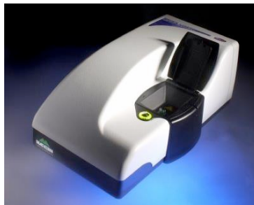
Figure 73 : Zetasizer utilisé pour la mesure de la taille et du potentiel zêta des nanoparticules formées
