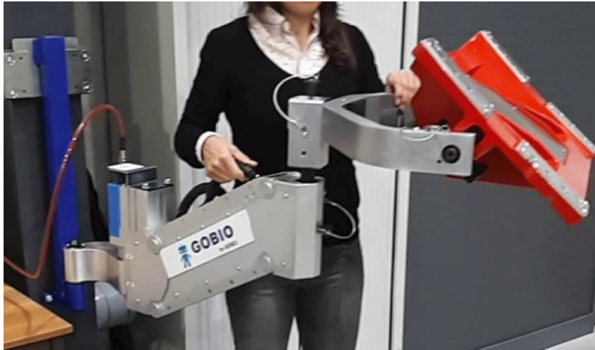
Figure 3. Un 'bras zéro gravité pneumatique' (Europe Technologies, 2019) aide l'opérateur à positionner une pièce lourde avec un effort très faible.
