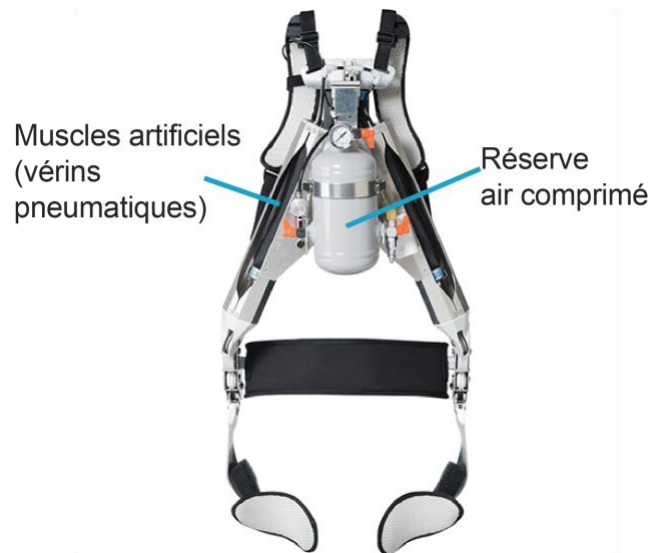
Figure 6. L'exosquelette pneumatique Innophys (Innophys CO, LTD), 2018.
