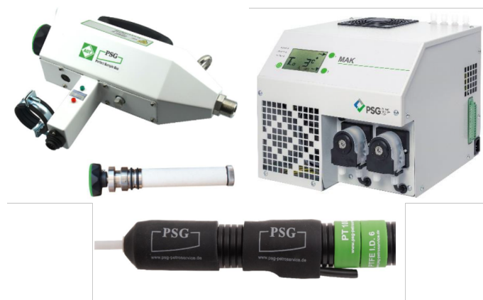
FIGURE 4.2 – Équipements d'échantillonnage des gaz : sonde de prélèvement chauffée et son filtre céramique intégré en haut à gauche, refroidisseur-sécheur en haut à droite et ligne chauffée en bas. Crédit CleanAir .
