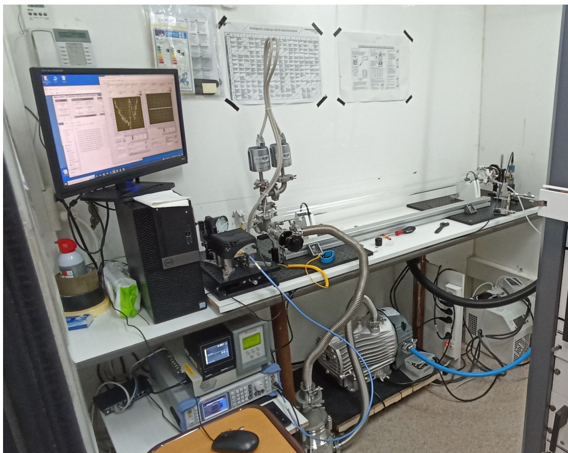
FIGURE 4.1 – Photo du spectromètre sur site. Éléments électronique à gauche, avec PC pilote en haut, contrôleur de pression et de pompage, détection synchrone et synthétiseur RF en bas. Spectromètre au centre, avec source cellule et détection en haut, et groupe de pompage en bas. Éléments d'échantillonnage en bas à droite avec ligne chauffée et groupe froid/sécheur.
