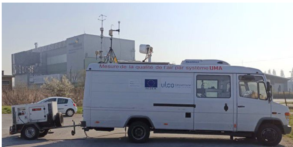
FIGURE B.3 – Unité Mobile Atmosphérique installée à proximité du CVE lors de la campagne de mesure. Les différents instruments sont visibles sur le toit du véhicule. En arrière plan, le CVE ou l'on aperçoit la cheminée d'émission dépassant du toit.
