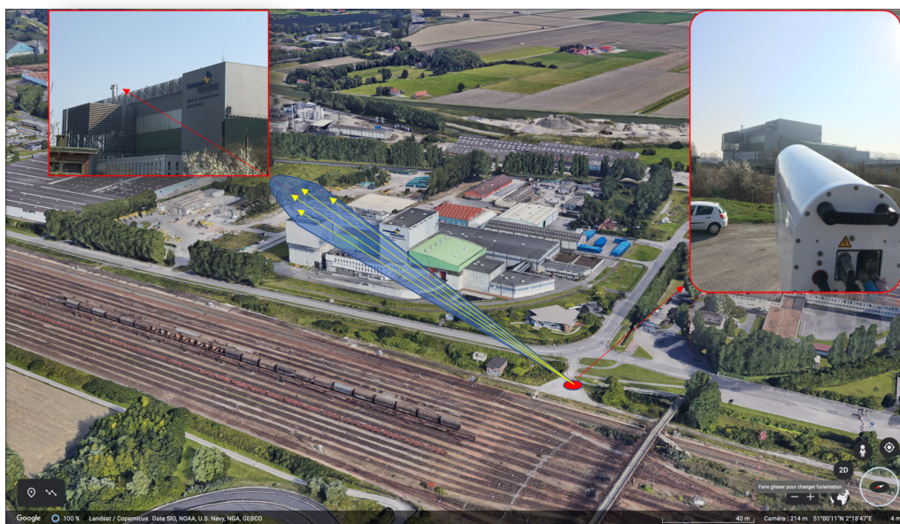
FIGURE B.4 – Photo aérienne du site et méthodologie de balayage horizontal du panache.
