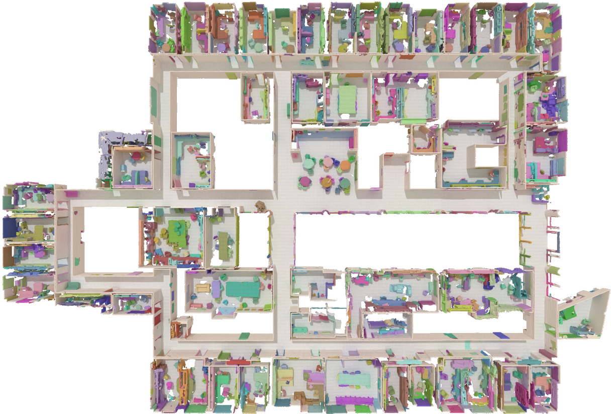
FIGURE E-4 – Segmentation Panoptique à Grande Échelle . Nous présentons les résultats de SuperCluster pour l'ensemble de la Zone 5 de S3DIS [14] (plafond supprimé pour la visualisation) avec 9.2 millions de points (78 millions avant sous-échantillonnage) et 1863 objets "things". Notre modèle peut traiter une telle scène en une seule inférence sur un seul GPU V100-32GB en 3.3 secondes et atteindre un PQ de pointe de 46.3.
