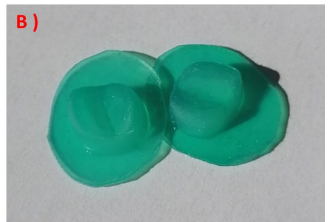
Figure 36 : (A) Illustration du fichier STL de la partie A du moule (B) Partie A en résine « flexible green »
