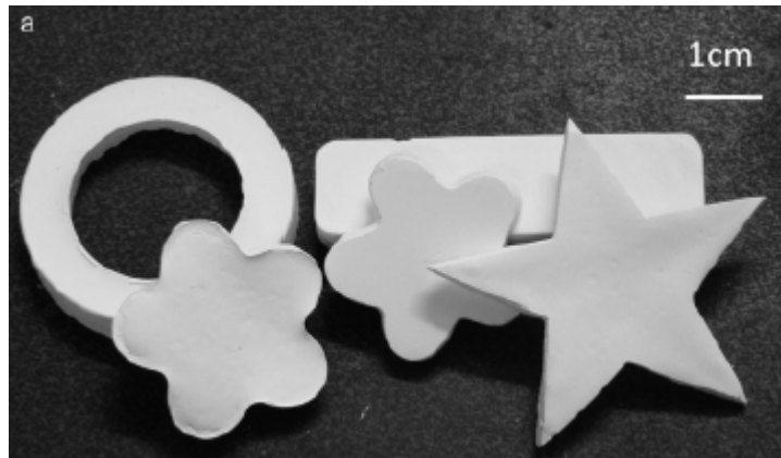
Figure 26 : Pieces en alumine mise en forme par gelcasting à partir de méthylcellulose [110]
