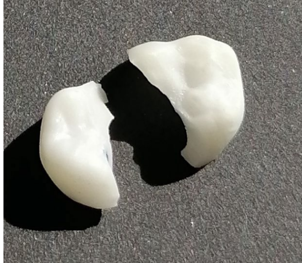
Figure 57 : Pièce frittée mise en forme par "gel casting" fissurée après séchage
