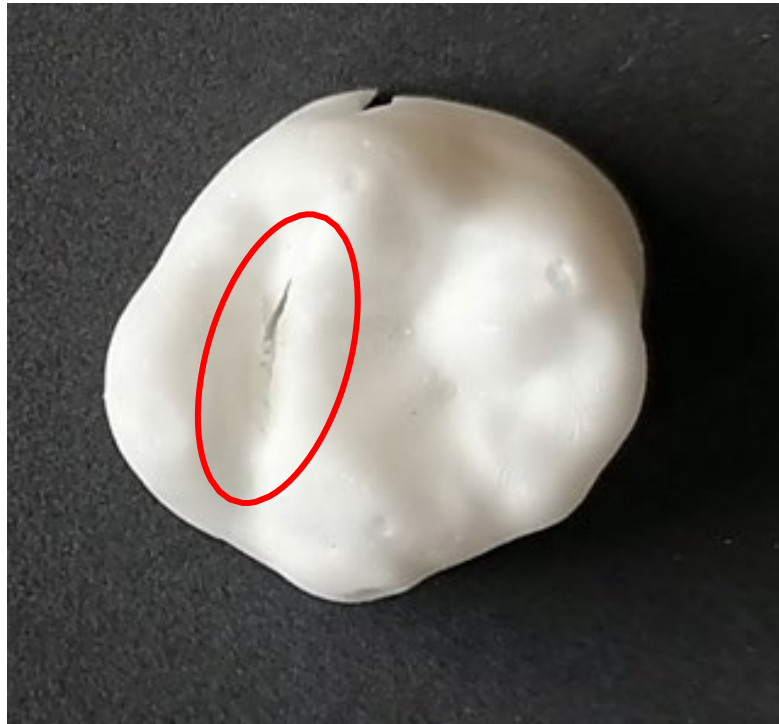
Figure 58 : Face supérieure fissurée d' une « couronne dentaire »
