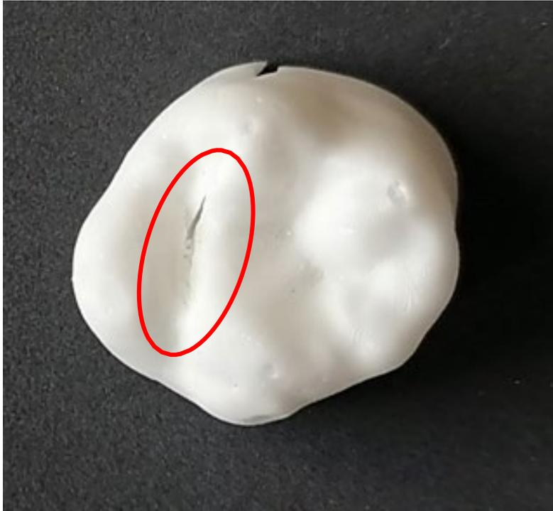
*Figure 58 : Face supérieure fissurée d' une « couronne dentaire »*
