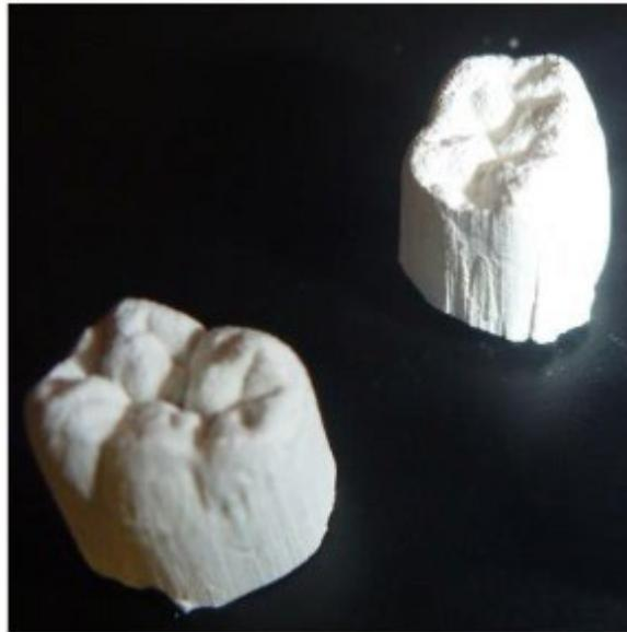
*Figure 5 : Photographie de couronnes dentaires en zircone obtenues par usinage laser [43].*
