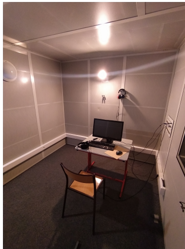
FIGURE 2.7 – Salle de réécoute du LVA Volume \approx 18 m 3 , Hauteur = 2.2 m, Longueur = 3.4 m, Largeur = 2.4m
