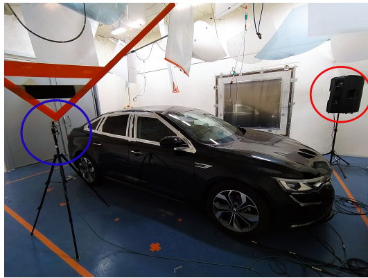
(A) Excitation par une enceinte (entourée en rouge ). (B) Niveau de pression mesuré en champ lointain dans la salle réverbérante Mesure du spectre par un microphone champ lointain (entouré en bleu ).
