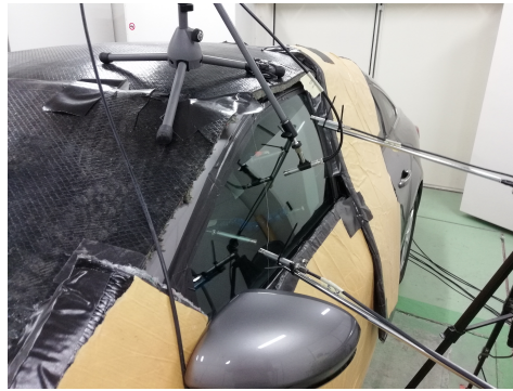
(B) Microphones positionnés de chaque côté du vitrage
