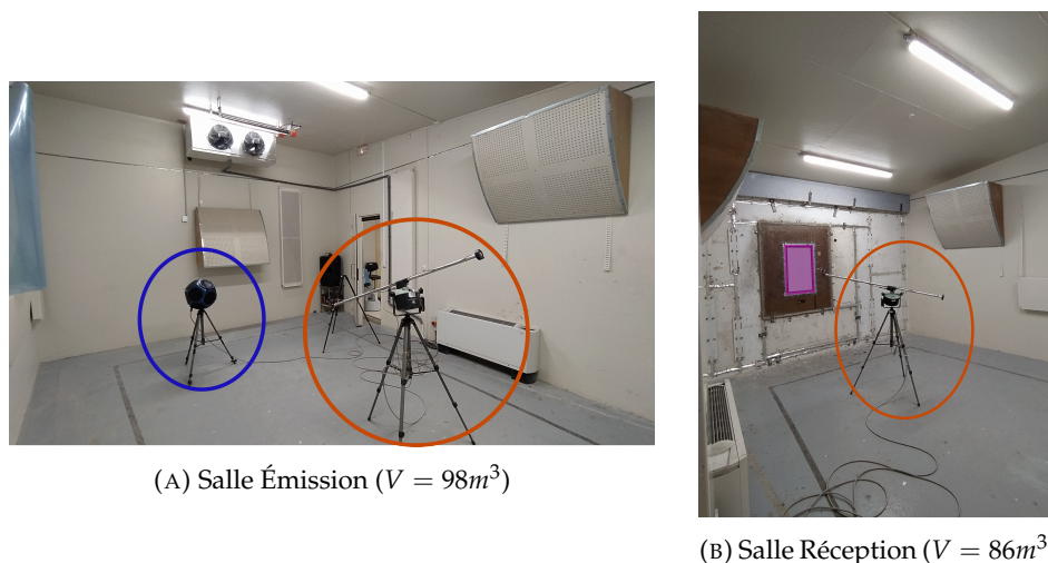
FIGURE 3.6 – Installation de mesures de pertes par transmission au centre SGRC :
