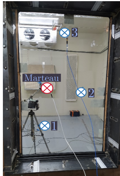
FIGURE 3.8 – Mesures réponses impulsionnelles Positions de l'accéléromètre (en bleu) Point d'impact (en rouge)
