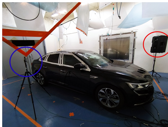
FIGURE 1.14 – Voiture placée dans la salle réverbérante exposée à un champ diffus généré par une enceinte (entourée en rouge). Le spectre est mesuré par un micro (entouré en bleu).
