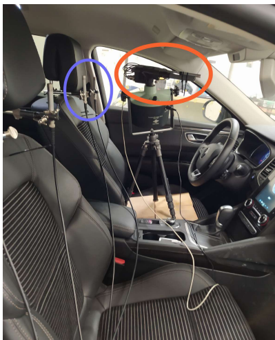
FIGURE 2.4 – Emplacement des microphones fixés sur l'appui tête conducteur (entouré en bleu ) et du microphone fixé sur un bras tournant utilisé Chap.3.3.2.1 (entouré en orange )
