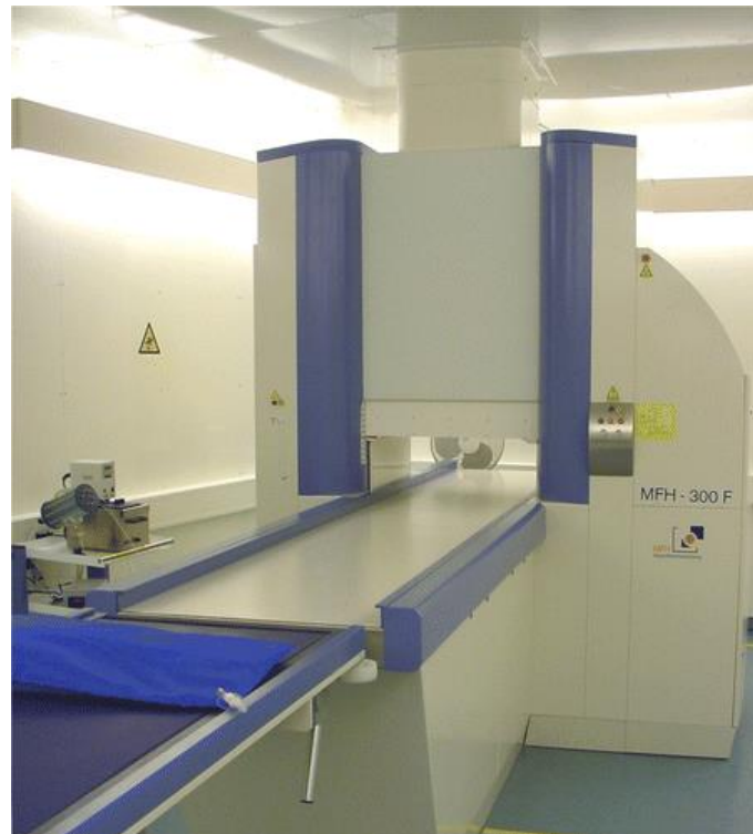
Figure 14: Applicateur de champ magnétique alternatif pour l'homme (NanoActivator F100, MagForce Nanotechnologies AG, Berlin) fonctionnant à une fréquence de 100 kHz et une intensité de champ variable de 0 à 15 kA/m.
