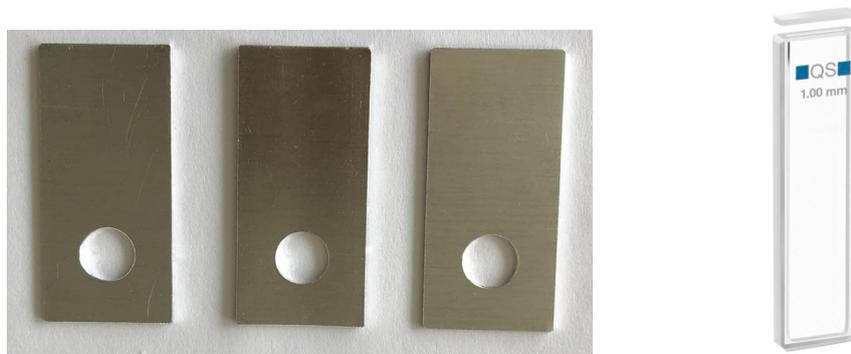
Figure 21 : Photos des cellules échantillons utilisées pour les expériences de diffusion des neutrons aux petits angles (DNPA). À gauche, des plaques en aluminium de 5\*2,3 cm et de 1 mm d'épaisseur, percées d'un cercle de 1 cm de diamètre. À droite, des cellules en quartz, d'épaisseur de trajet optique 1 mm.
