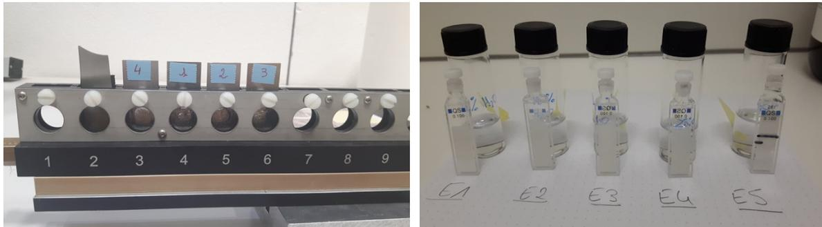
Figure 25 : Photos des échantillons utilisés pour les expériences de diffusion des neutrons aux petits angles (DNPA), montrant les deux types de cellule utilisés : des plaques en aluminium percées d'un cercle (à gauche) et des cellules en quartz (à droite).
