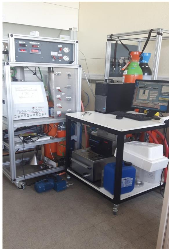
*Figure 16 : Montage expérimental pour la formation d'hydrates de gaz. Il est constitué d'un bain d'huile siliconée (ou mélange eau/éthanol) permettant de réguler la température des échantillons, d'une pompe seringue contenant le gaz (ou mélange de gaz) et connectée à un ordinateur, permettant de réguler la pression dans les cellules échantillons.*
