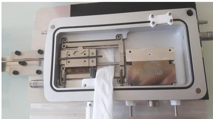
Figure 19 : Capillaire collé (en cours de séchage) dans la cellule Linkam capillaire pour les études in-situ.
