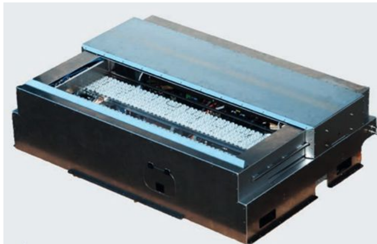
FIGURE 2.7 – Système de mesure de l'usure du fil de contact développé par l'institut Fraunhofer (Fraunhofer-Gesellschaft, 2016).
