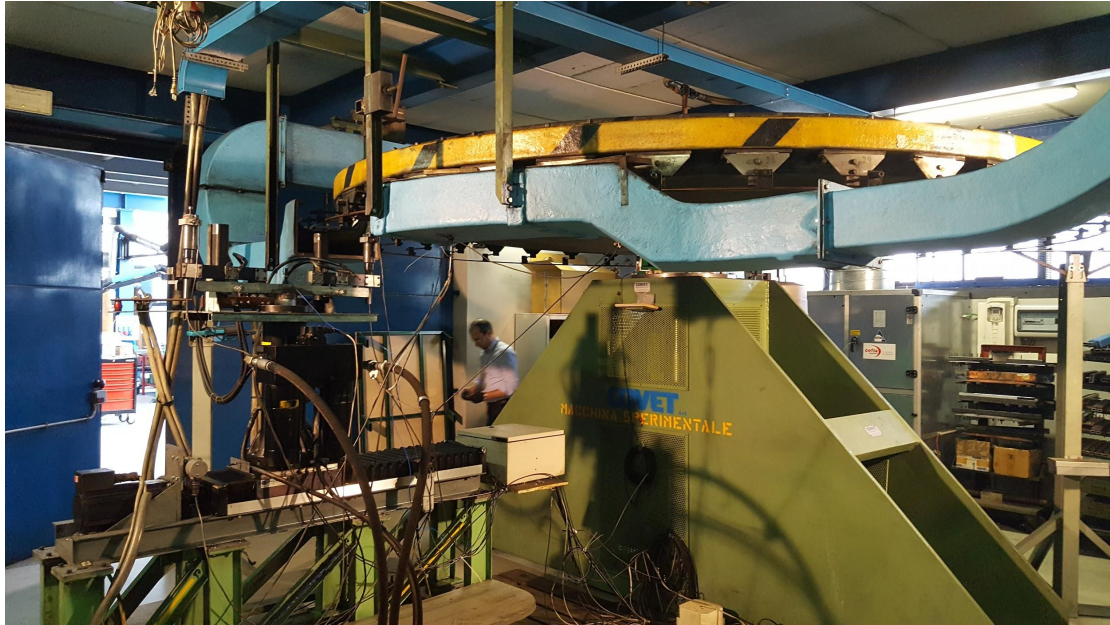
FIGURE 4.10 – Banc d'essai d'usure simulant l'interaction pantographe-caténaire ((Bocciolone et al., 2004)).
