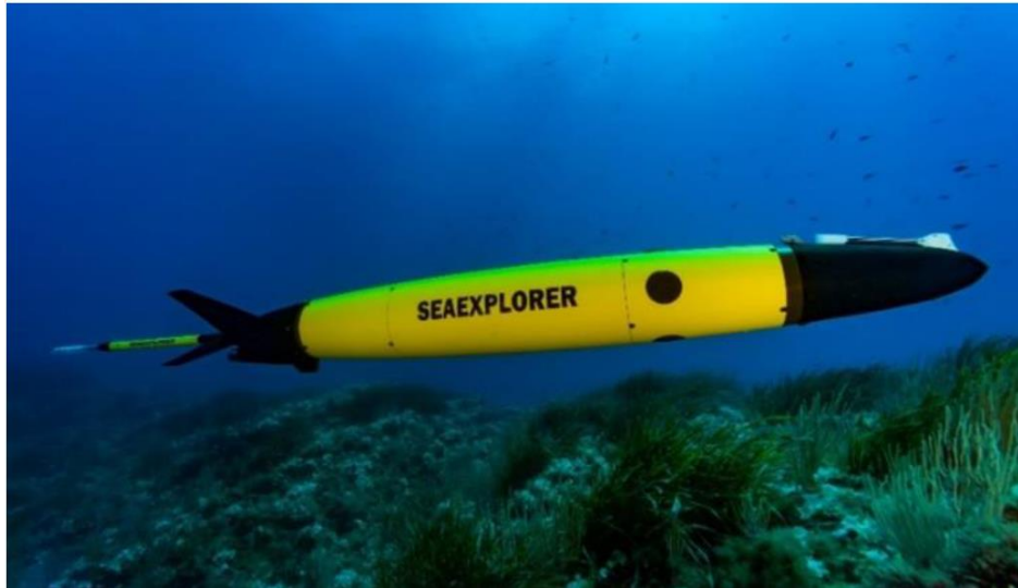
Figure 3.2. Planeur sous-marin SeaExplorer. Crédits : Alseamar
