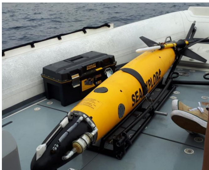
Figure 2.5. Planeur sous-marin SeaExplorer utilisé pour réaliser un échantillonnage d'ADNe. Crédit A. Duhamet
