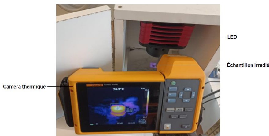
Figure 1 : Montage expérimental de l'irradiation d'un échantillon par une LED à 850nm suivi par caméra thermique.
