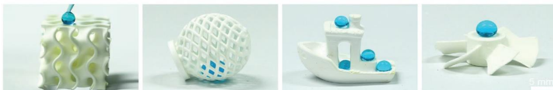
Figure 2 : Objets super hydrophobes de forme complexe imprimés à l'aide de la résine proposée dans l'article ; extrait de [49].
