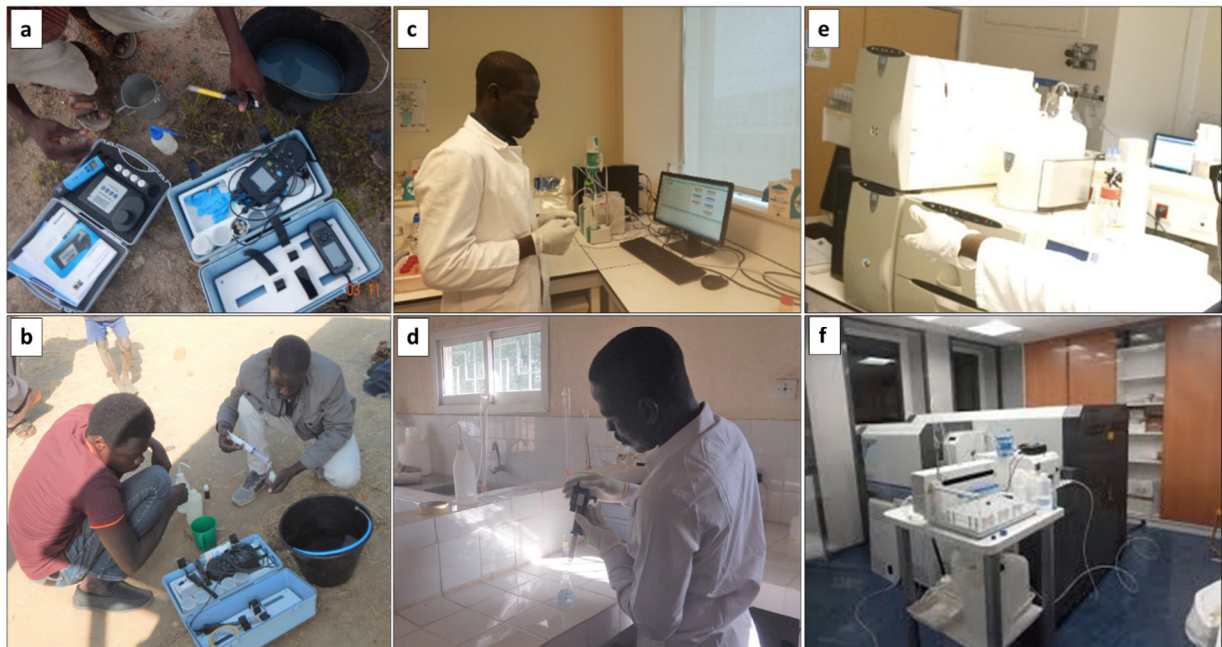
Figure III.40 : (a) Mesures des paramètres physico-chimiques, (b) Echantillonnages, (c) Mesure de l'alcalinité à l'aide du titrateur Metrohm 950 Titrado au laboratoire METIS à Sorbonne Université, (d) Mesure de l'alcalinité à l'aide du système de titration Hach au laboratoire régional d'analyse des eaux de Mongo, (e) Analyse \text{Na}^+ , \text{K}^+ , \text{Ca}^{2+} , \text{Mg}^{2+} , \text{Cl}^- , \text{SO}_4^{2-} , \text{NO}_3^- , \text{F}^- par chromatographie ionique liquide et ICP-OES au laboratoire METIS, (f) Analyses isotopiques : ^{18}\text{O} et ^2\text{H} au laboratoire GEOPS à l'Université Paris-Saclay.
