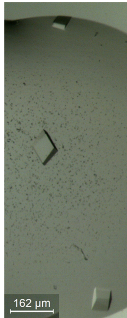
Figure 63 : Cristaux de apo-MmLarE obtenus après optimisation manuelle des conditions de cristallisation dont le sulfate d'ammonium est le principal agent précipitant (Article, Material and methods)
