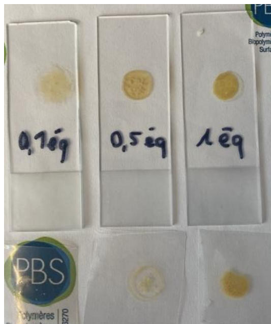
Figure III- 29 : Photo des revêtements sur plaque de verre (en haut) et des résidus sur le film de PE (en bas) en fonction de la quantité de MMC
