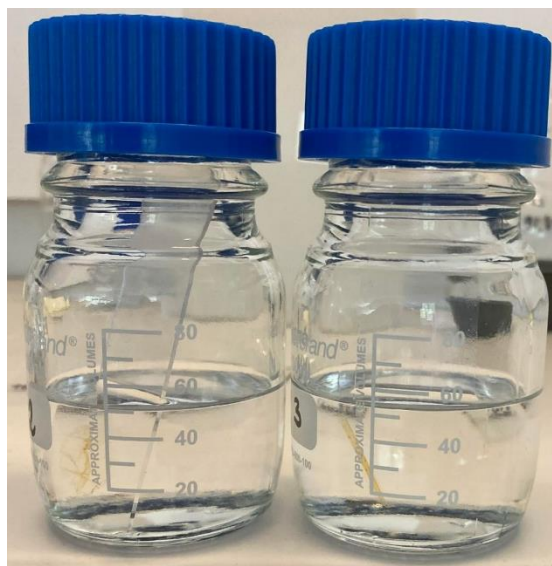
Figure IV- 7: Photo des films réticulés après immersion dans le DCM pendant 24h
