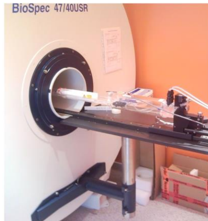
Figure 22. IRM Brucker Biopsec 4.7 T/30 (Brucker, Allemagne) utilisée pour le petit animal
