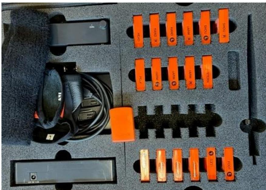
*Figure annexe 4 : Centrales inertielles XSENS*
