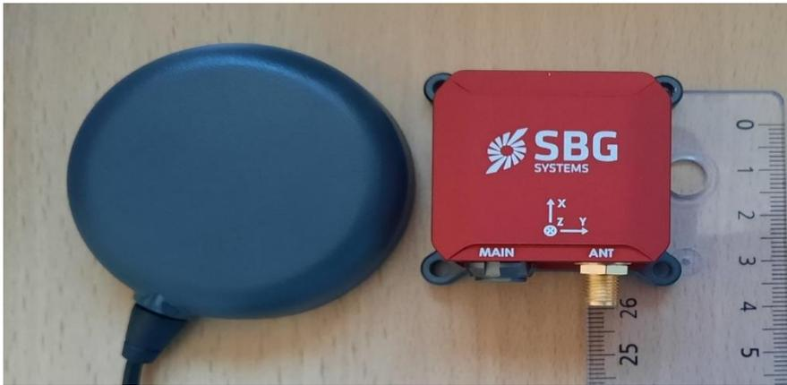
*Figure annexe 8 : Photographies de l'antenne GPS et de l'IMU associé ainsi que le câble USB.*
