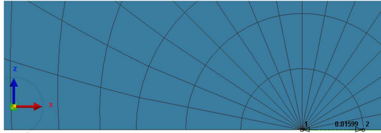
Figure A3_17 : taille de maille en avant du front de fissure dans le plan de symétrie
