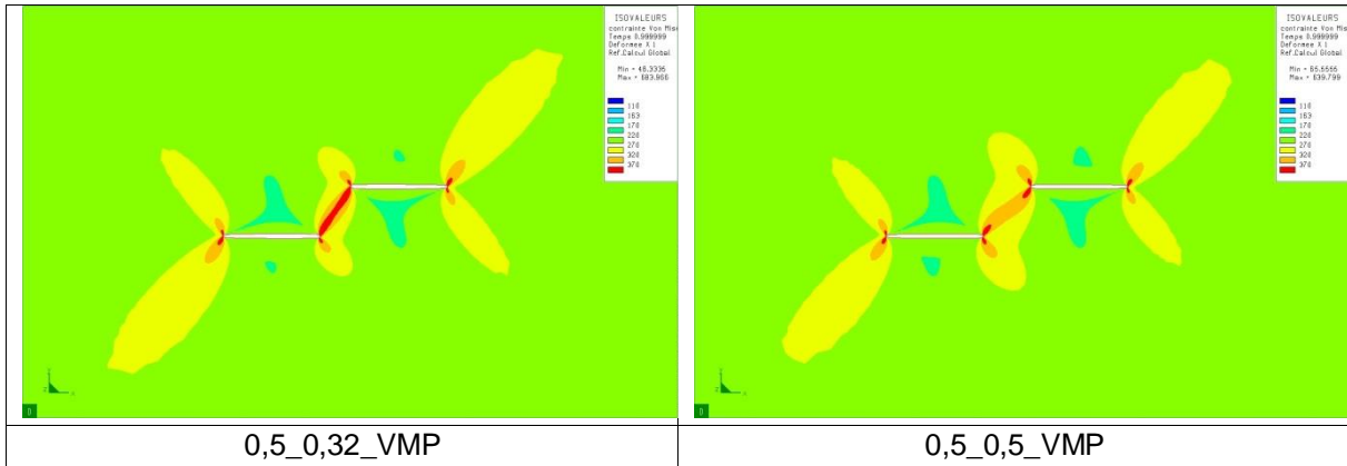
Figure 4_22 : contraintes élastoplastiques de von Mises pour \hat{S}_z = 0,5 avec \hat{S}_x = 0,36 et 0,5
