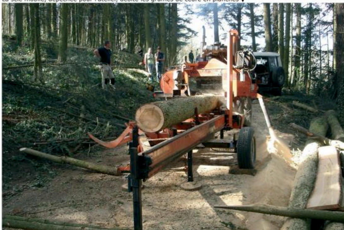
La scie mobile, dépêchée pour l'atelier, débite les grumes de cèdre en planches ▼
