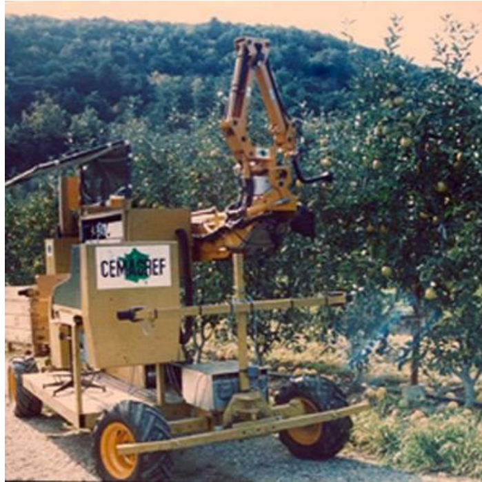
Figure 5 : Magali le robot cueilleur de pomme développé dans les années 1980 par le CEMAGREF
