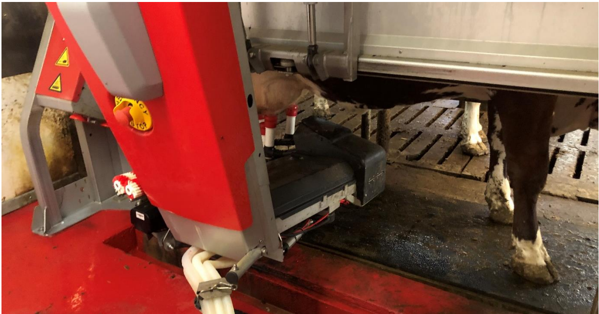
Figure 1 : Le robot de traite en action : branchement des gobelets trayeurs par le bras mécanique d'un robot Lely (source : T. Martin, 2021)
