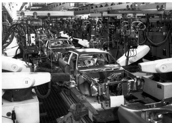
Figure 4 : En 1961, Unimate, le premier robot, fait son apparition sur une chaîne de production de General Motors. Ce robot assemble des pièces métalliques pour la construction automobile - crédit : Aeolus Robotics
