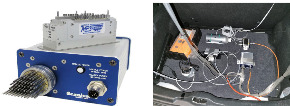
Figure 2.4: Visualisation du Scanner Scanivalve MPS4264 ainsi que son positionnement dans le coffre à gauche et à droite respectivement.
