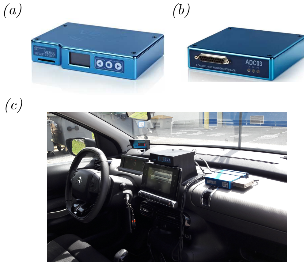
Figure 2.3: Visualisation du boîtier VBOX Racelogic ainsi que le Convertisseur CAN. (a) et (b) visualisation du boîtier VBOX Racelogic et du convertisseur CAN respectivement. (c) Visualisation de l'installation dans la voiture.
