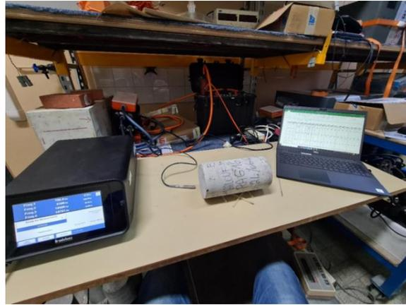
Figure 48: Essai du module dynamique par résonance libre
