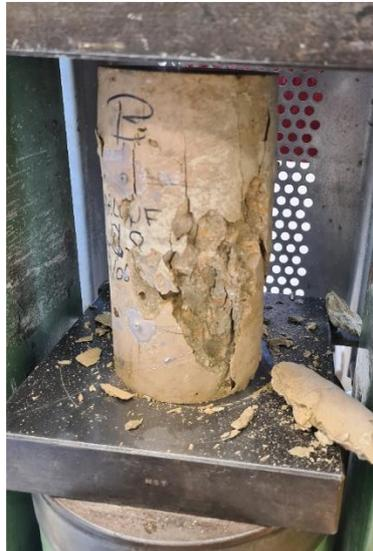
Figure 46: Résistance en compression des éprouvettes
