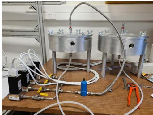
Figure 8: Perméamètre à charge constante, en surpression : Cembureau
