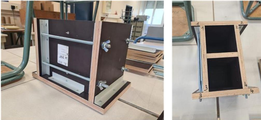
*Figure 37: Présentation de l'état final des moules des éprouvettes prismatique*
