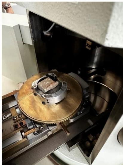
*Figure 42: Echantillon à tester placé dans la chambre du MEB*
