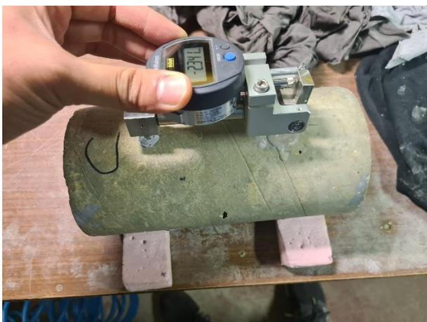
(a) Suivi des éprouvettes cylindriques
