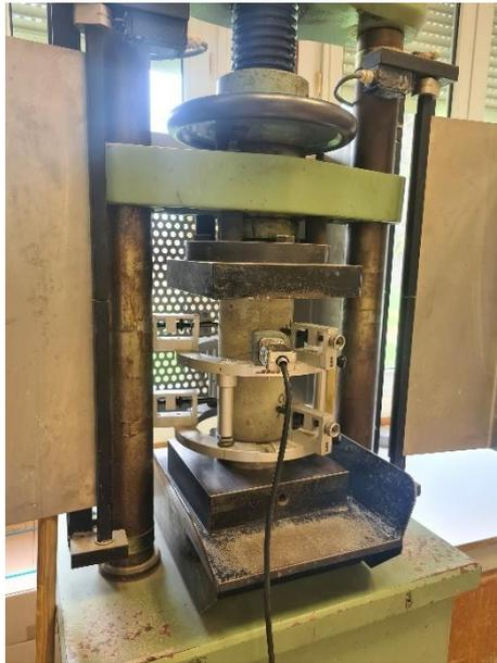
Figure 47: Essai du module statique par cage d'extensométrie
