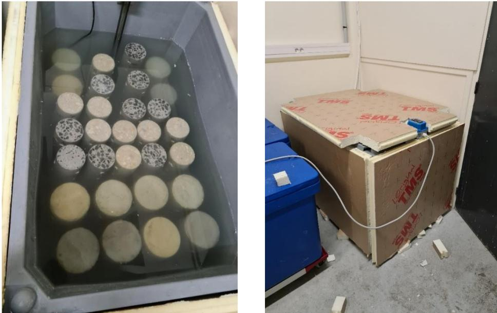
Figure 32: Bac de conservation équipé d'une pompe et d'une résistance thermique
