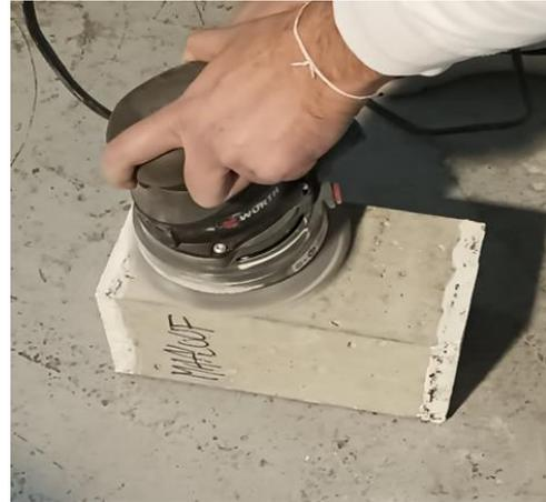
Figure 39: Résinage des éprouvettes prismatiques et élimination de la rugosité
