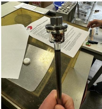
Figure 41: Cellule de mesure contenant l'échantillon à tester
