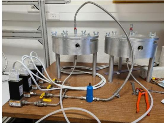
Figure 44: Perméamètre Cembureau
