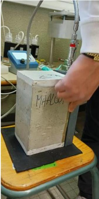
(a) Application de la graisse sur l'interface cloche/éprouvette
