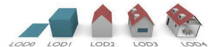
Figure 33 : Niveaux de détails de la version 2.0 du CityGML, Biljecki et al.(2016)
