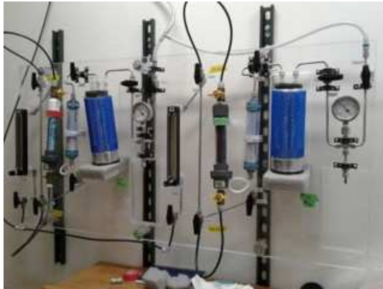
FIGURE 2.10 – Photos de deux lignes d'émanation du radon au WHOI.
