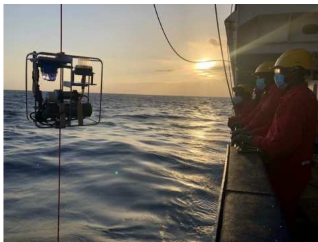
FIGURE 2.2 – Photo d'une pompe in-situ déployée lors de la campagne SWINGS.
