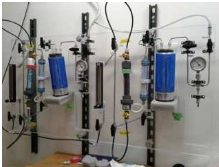
FIGURE 2.10 – Photos de deux lignes d'émanation du radon au WHOI.
