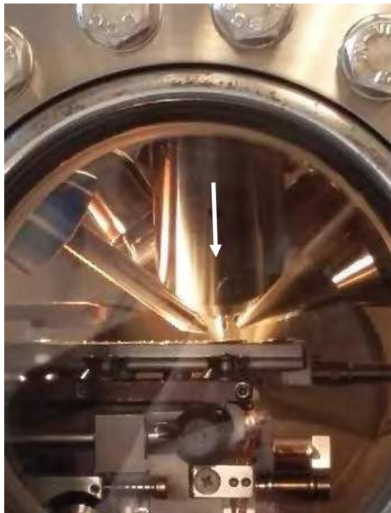
Figure 50 : Photographie de la zone d'acquisition du TOF-SIMS. On peut voir la platine, au-dessus de laquelle s'avance les différents accessoires nécessaires à l'acquisition. Le colonne permettant le vol et la détection des ions (flèche blanche) occupe tout l'espace à la perpendiculaire de l'échantillon, la caméra est obligatoirement inclinée ce qui peut complexifier l'acquisition.
