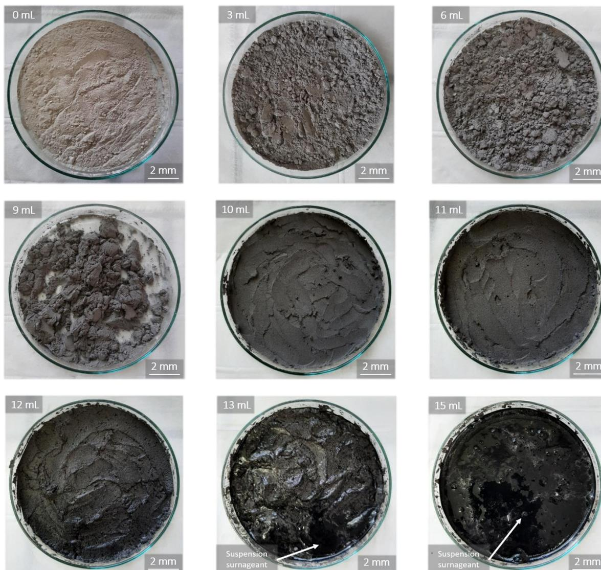
Figure 86 : Mélanges Ag-NTC3SDS en fonction du volume de suspension NTC3SDS ajouté
