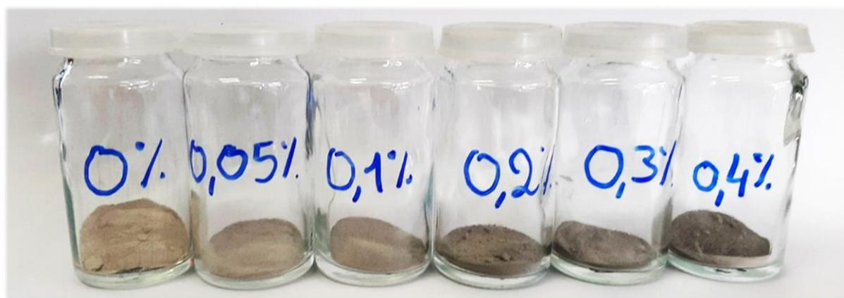
Figure 92 : Photographies des poudres Ag-NTC3SDS après séchage
