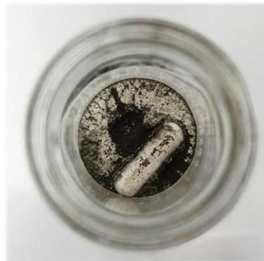
Figure 84 : Vue du dessus du mélange de la poudre d'Ag modifiée avec du PVP avec la suspension NTC3SDS après séchage à l'étuve
