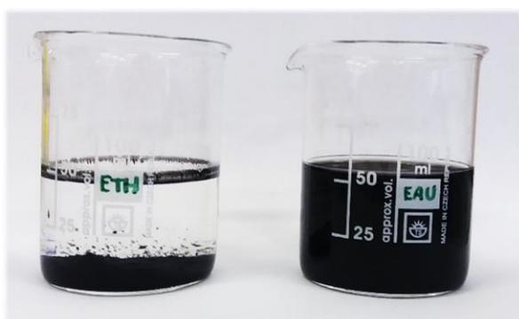
Figure 109 : Immersion des particules séchées de NTC2SDS(0,4) dans de l'éthanol (gauche) ou dans de l'eau (droite)
