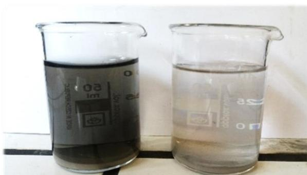
Figure 107 : Immersion d'une poudre Ag-NTC2SDS dans de l'eau (gauche) ou dans de l'éthanol (droite)
