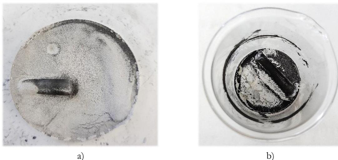
Figure 80 : Vue du dessus des mélanges de la poudre d'Ag avec les suspensions a) NTC2SDS et b) NTC3SDS après séchage à l'étuve
