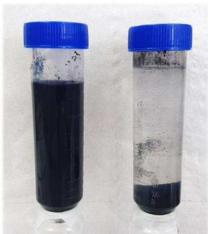
Figure 72 : Deux tubes après centrifugation du lot NTC3 fonctionnalisés pendant 24 h et mis en suspension. Une suspension est stable (gauche) tandis que l'autre ne l'est pas (droite)
