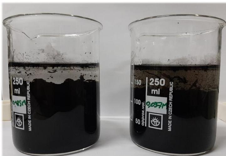
Figure 132 : Photographies montrant l'agglomération des NTC due à la présence d'ions Ag<sup>+</sup> en solution (0,185 M à gauche et 0,037 M à droite)
