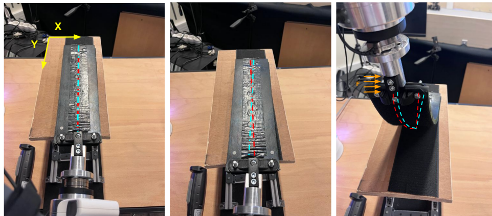
(a) Trajectoire du préhenseur et bande parfaitement alignées (b) Léger désalignement (c) Forces de rappel F exercées sur le préhenseur durant la manipulation
