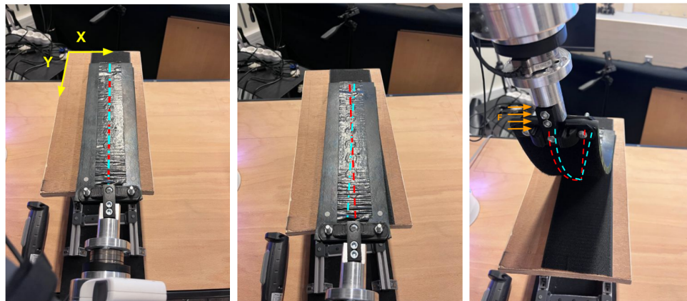
(a) Trajectoire du préhenseur et bande parfaitement alignées (b) Léger désalignement (c) Forces de rappel F exercées sur le préhenseur durant la manipulation
