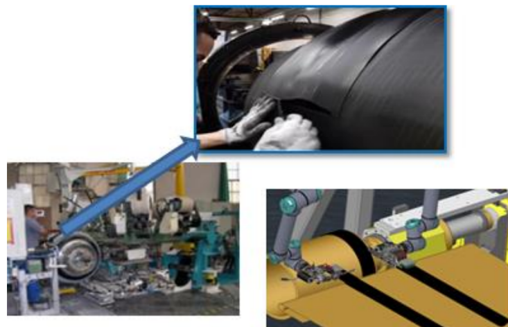
FIGURE 1.5 – Processus d'assemblage de pneus - cas d'étude Michelin
