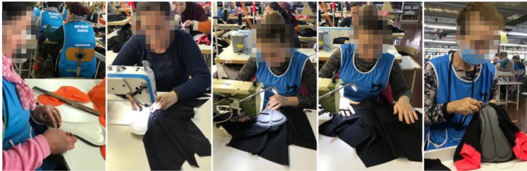
FIGURE 1.6 – Assemblage manuel puis couture d’un pad en mousse sur un textile - cas d’étude Decathlon
