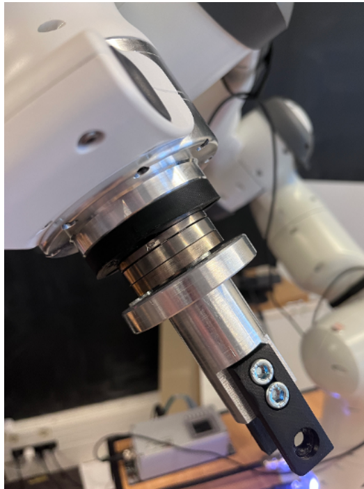
FIGURE 4.4 – Capteur de force fixé au poignet du robot qui mesure les forces et moments appliqués au point de saisie
