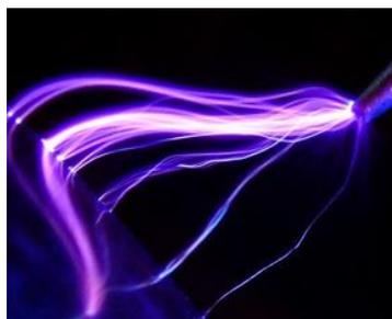
**Figure I.14.** Exemple de décharge de couronne [57].
