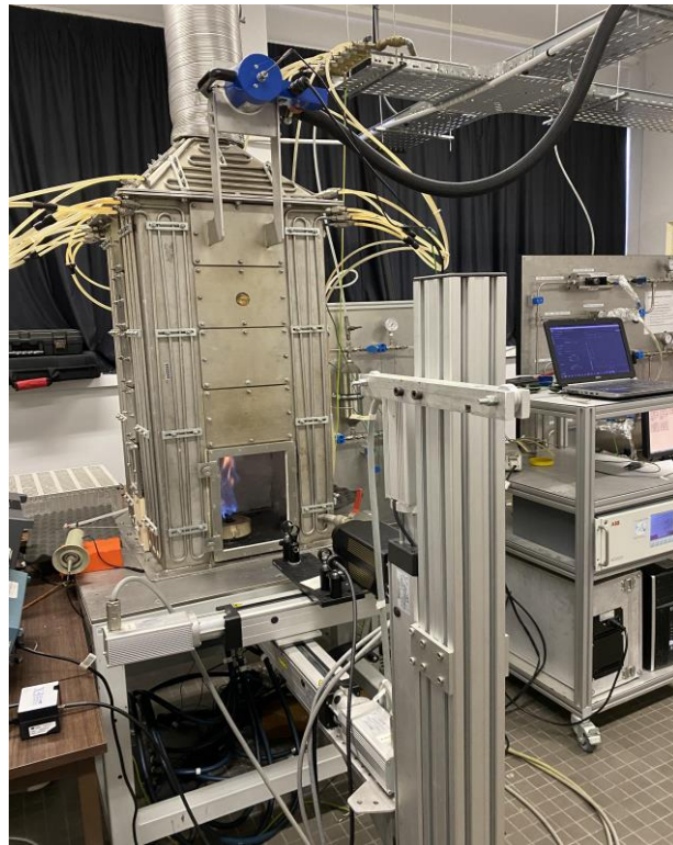
Figure II.1. Photographie de la chambre de combustion.
