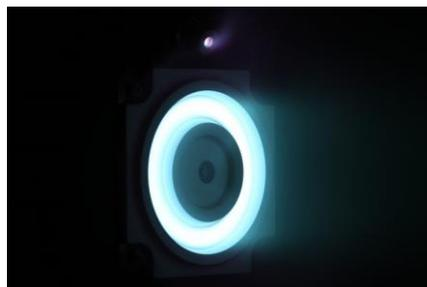
**Figure I.18.** Propulseur à effet hall PPS@5000 [63].
