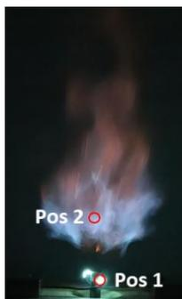
**Figure IV.39.** Positions d'acquisition pour la spectroscopie d'émission.
