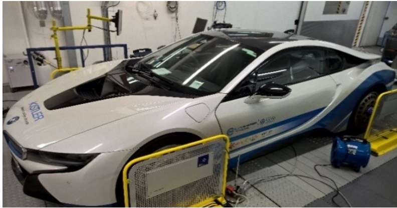
Figure 2.17: Le véhicule testé installé sur le banc d'essai [156]
