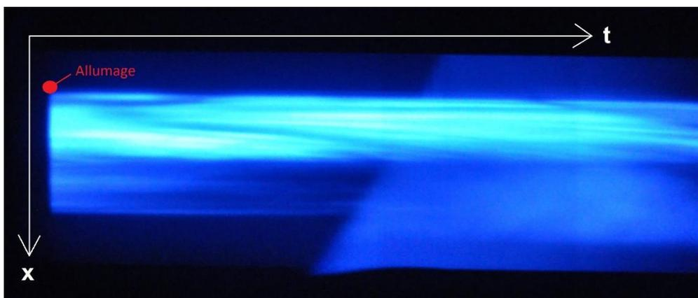
Figure II.26 - Cliché pris avec la caméra à fente présenté sous forme de diagramme  $x-t$
