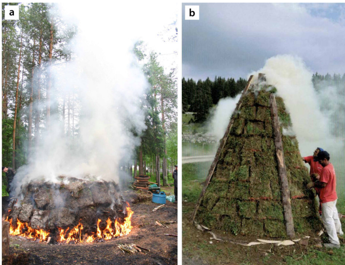
Figure 31 : Exemples d'emplois de plaques de gazon dans des structures de combustion artisanales (a) Expérimentation d'un four à goudron de pin en Finlande, herbes tournées vers l'intérieur de la meule (crédits : Matkailuneuvonta, « Terva palaa », 2005 ; Wikimedia Commons). (b) Reconstitution d'une meule pour la fabrication de sable rouge pour la fabrication d'enduit à la chaux, dans le Jura neuchâtelois (Marc Forestier, 2015 ; référence transmise par Vincent Bichet). L'intérieur de la meule est entièrement composé de billes de bois fendues et dressées. Une seule couche de mottes de terre, épaisses d'une quinzaine de centimètres d'épaisseur clôture le tout, herbes à l'extérieur.
