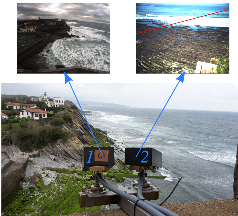
FIGURE 5.6 – Photographie des caméras et prise de vue de chaque caméra, avec le transect considéré en rouge.
