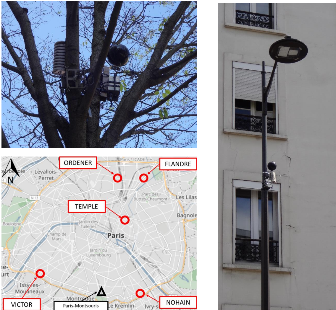
Fig. 2 : Photographies du dispositif expérimental de l'étude Arbres et Climat. En haut à gauche : capteurs dans le houppier d'un arbre. A droite : capteurs montés sur un candélabre de référence. En bas à gauche : carte des sites instrumentés et localisation de la station Météo-France Paris-Montsouris.
