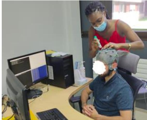
Figure 9 : Mise en place du dispositif d'enregistrement EEG par la doctorante.
