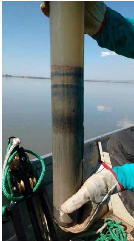
Figura 2 – Testemunho de sedimentos coletado utilizando um coletor de testemunho por gravidade.
