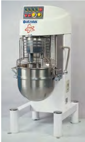
Figure II. 6 : Malaxeur de 10 litres initialement utilisé pour la mise au point des formulations
