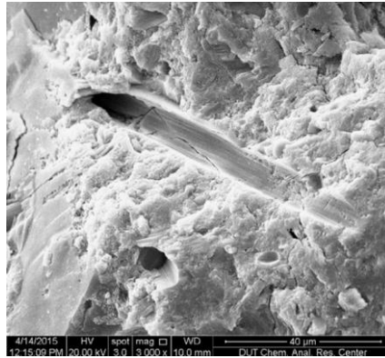
Figure I.10 : Empreinte laissée par une fibre de carbone après avoir été retirée de la matrice cimentaire [29]
