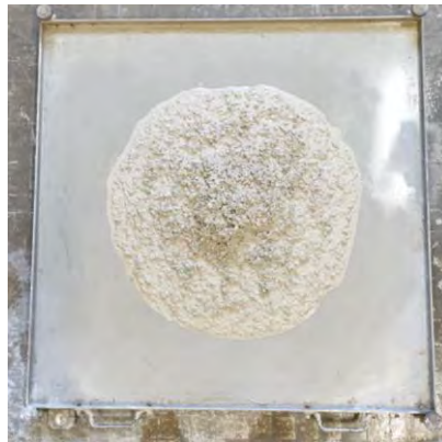
Figure II. 5 : Exemple d'un étalement au cône d'Abrams obtenu pour un dosage de 20 kg/m 3 de FIBRAFLEX
