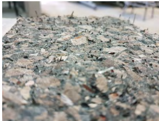
Figure II. 32 : Faciès de rupture d'une éprouvette renforcée par des FIBRAFLEX
