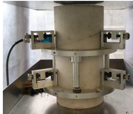
Figure II. 17 : Cage extensométrique utilisée pour la déformation longitudinale
