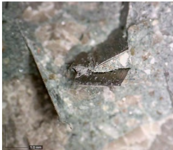
Figure II. 25 : Interaction néfaste entre deux fibres Fibraflex (observation au microscope optique)
