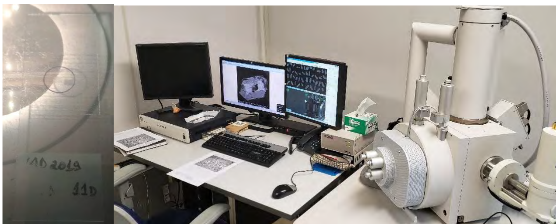
Figura 20: Montagem de mount (esquerda); MEV FEI Quanta™ 450 do LEGGA-IG-UnB (Retirado de www.legga.unb.br )
