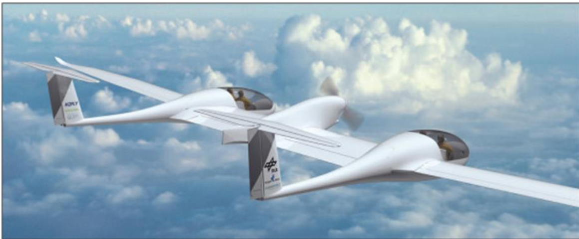
Figure 98: Avion HY4 à quatre places alimenté par quatre (4) PAC de 11 kW, développé par le centre allemand pour l'aéronautique et l'astronautique « DLR German Aerospace Center » / [Kallo, 2015]
