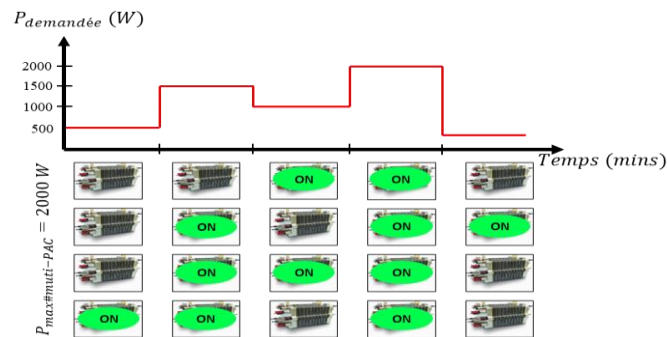
Figure 8: Répartition d’une demande entre des PAC identiques de 500 W en n’activant que le minimum PAC nécessaire
